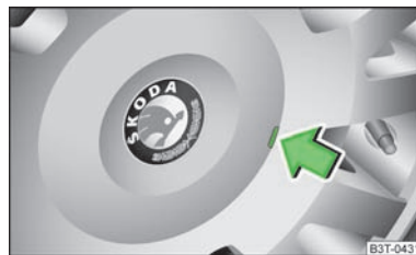
Rys. 129 Zdejmowanie kołpaka ozdobnego z koła z obręczą ze stopów lekkich
