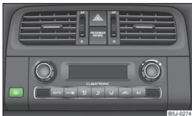
Rys. 28 Włącznik ogrzewania szyby tylnej
