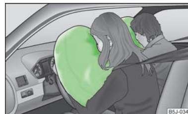
Rys. 101 Poduszki bezpieczeństwa napędlone gazem
