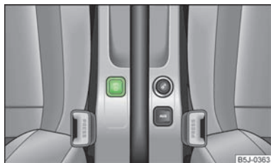
Rys. 130 Przycisk do ustawiania wartości kontrolnej ciśnienia powietrza w kołach
