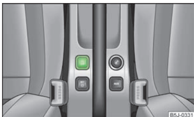
Rys. 85 Konsola środkowa: Przycisk układu START-STOP
