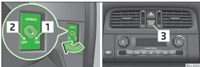
Rys. 106 Wyłącznik kluczykowy czołowej poduszki bezpieczeństwa pasażera /lampka kontrolna wyłączonych czołowych poduszek bezpieczeństwa pasażera
