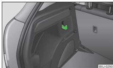
Rys. 43 Bagażnik: rozkładany hak
