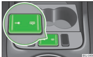
Rys. 12 Konsola środkowa: Przycisk centralnego ryglowania
