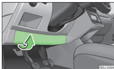
Rys. 142 Spód tablicy rozdzielczej: pokrywa skrzynki bezpieczników
