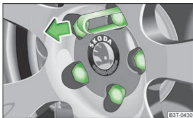
Rys. 128 Zdejmowanie kapturka ochronnego
