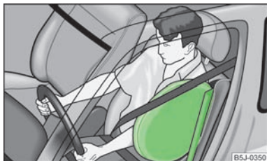
Rys. 103 Boczna poduszka bezpieczeństwa wypełniona gazem
