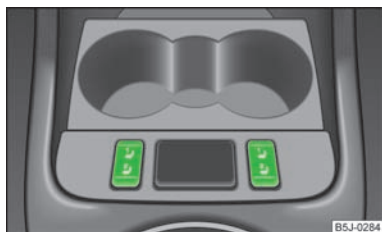
Rys. 37 Przelącznik dźwigienkowy ogrzewania foteli przednich
