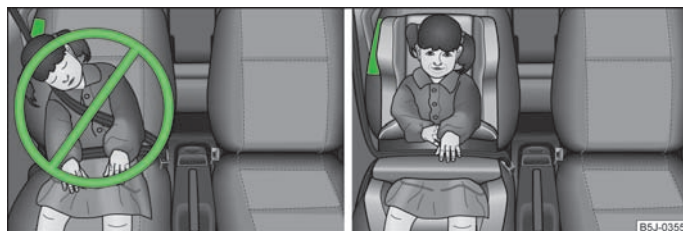
Rys. 108 Złe zabezpieczone dziecko, siedzące w niewłaściwej pozycji, zagrożone przez boczną poduszkę bezpieczeństwa/Dziecko właściwie zabezpieczone przez zastosowanie fotelika dziecięcego
