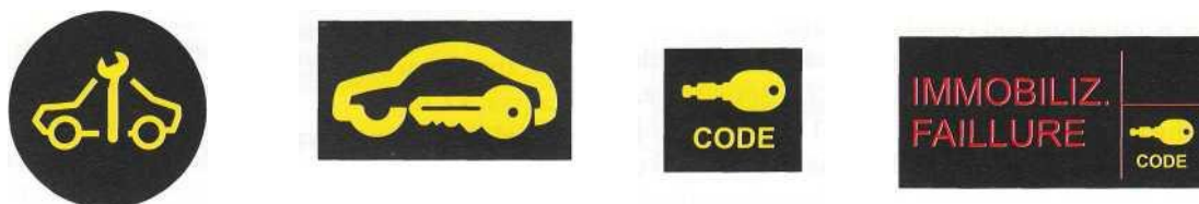
Rys. 12.2. Wygląd kontrolki immobilizera w różnych samochodach
